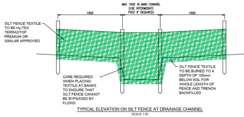
TYPICAL ELEVATION ON SILT FENCE AT DRAINAGE CHANNEL
