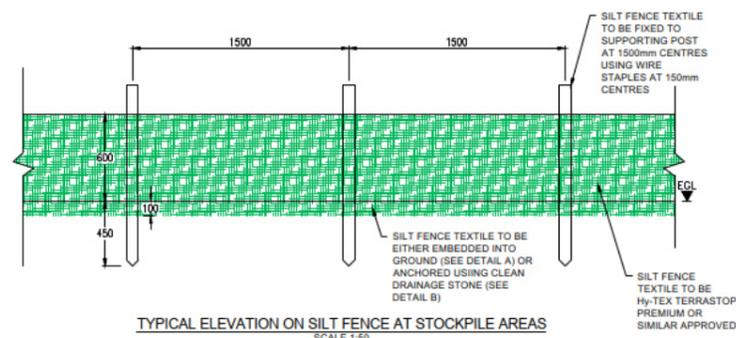
TYPICAL ELEVATION ON SILT FENCE AT STOCKPILE AREAS
