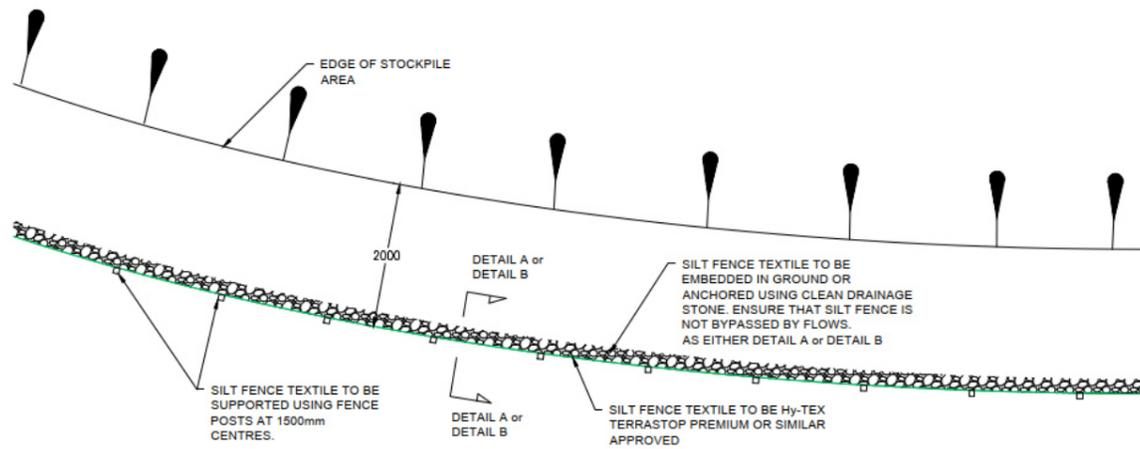
TYPICAL PLAN ON SILT FENCE AT STOCKPILE AREAS
